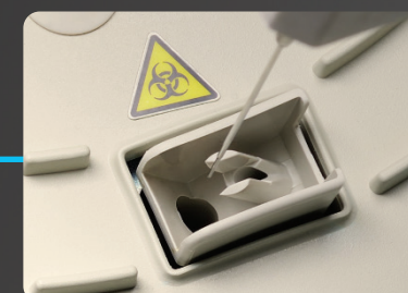
Limpieza de sonda de caída de agua
